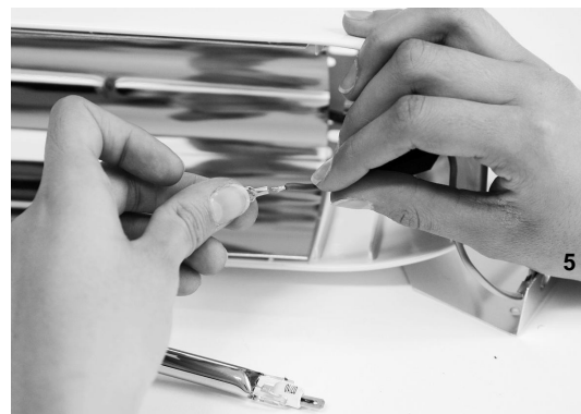
5. УБРАВ ИЗНОШЕННЫЕ ЧАСТИ, ВДЕНЬТЕ КАПСУЛЫ, ОЧИСТИТЕ ПРОВОДА НА ДЛИНУ 5-6 ММ. ВСТАВЬТЕ ИХ В СОЕДИНИТЕЛЬНЫЙ РАЗЪЕМЫ И ЗАФИКСИРУЙТЕ НА ПРОВОДЕ. НЕ ДОТРАНИВАЙТЕСЬ ДО ЛАМПЫ ГОЛЫМИ РУКАМИ.
