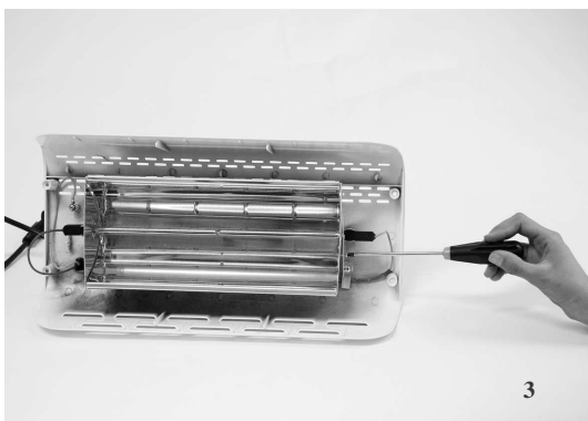
3. ОТКРУТИТЕ ВИНТЫ, ЗАКРЕПЛЯЮЩИЕ НЕБОЛЬШИЕ ЗАЩИТНЫЕ ДЕТАЛИ ПО БОКАМ ОБОРУДОВАНИЯ.
